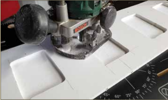
Mit einer Oberfräse wurden die FOREX-Platten im Bereich der Fenster auf einen Millimeter Stärke verdünnt.
