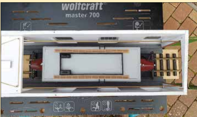
„Der Maus“ ist ein paar Millimeter vorgefahren. Die Kulisse wird freigegeben und der Gummizug öffnet das Tor.
