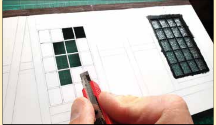
Mit Hilfe eines Cuttermessers wurden die filigranen Stege freigeschnitten. Schwarze Farbe und ein Stück Stuhlnunterlage als Scheibe vervollständigen das Fenster.
